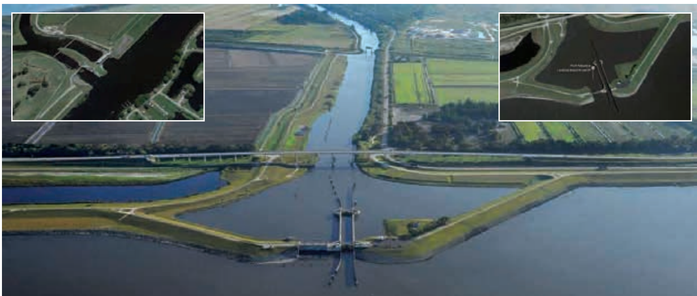
Herbert Hoover Dike, località Port Mayaca (Florida): veduta dall'alto e dettaglio delle zone dove TREVIICOS deve eseguire slurry wall e grouting. Herbert Hoover Dike, locality Port Mayaca (Florida): aerial view and detail of the areas where TREVIICOS must perform slurry wall and grouting.
